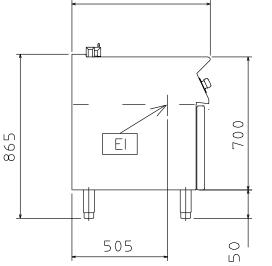
Electrical inlet (power) Equipotential screw
